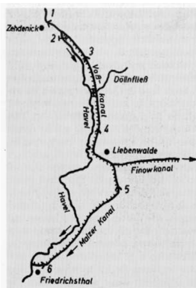
Bild 4.13 Abzweigung des Finowkanals aus der Havel und Speisung durch die Havel. Um 1790. Zeichnung: Autor
